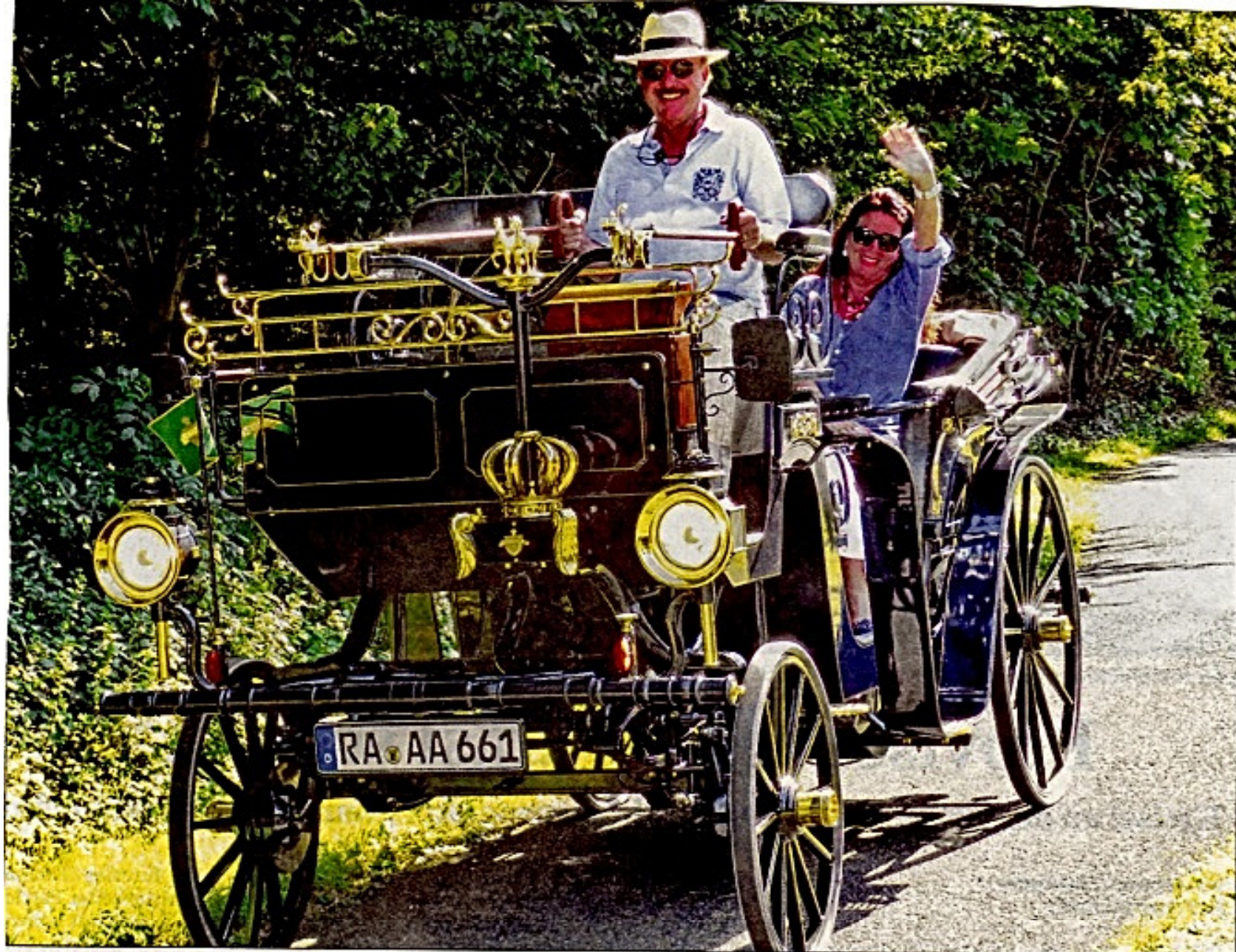
SELBER FAHREN ist das reinsten Vergnügen. Die Motorkutschen haben einen 20-PS-Dieselmotor. Gelenkt wird mit zwei Lenkstangen, die an die Zügel einer Kutsche erinnern sollen.
